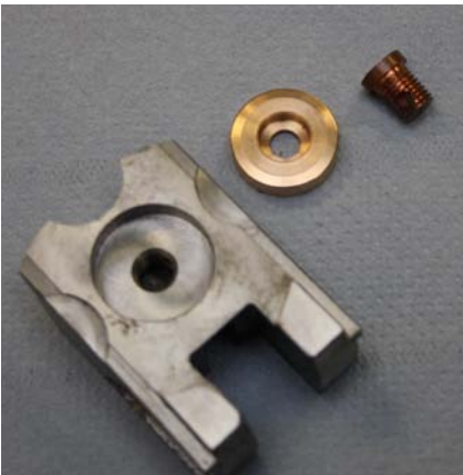
Die neueste Version des Zündeinsatzsystems (l.) mit Dichtplatte aus Beryllium-Bronze und Zündlocheinsatz aus Kupfer-Beryllium. Das „Ur-System“ (M.) fertigt inzwischen auch Pedersoli mit Helbachs Erlaubnis. Nach dem Reinigen, Ölen und Montieren des Blockes bläst Helbach (r.) ihn durch, um Ölreste aus dem Zündkanal zu entfernen.
